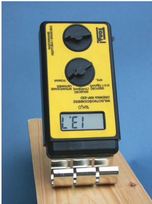
Rys. 2 Wilgotnościomierz pojemnościowy typ WIP-22D produkcji firmy TANEL
