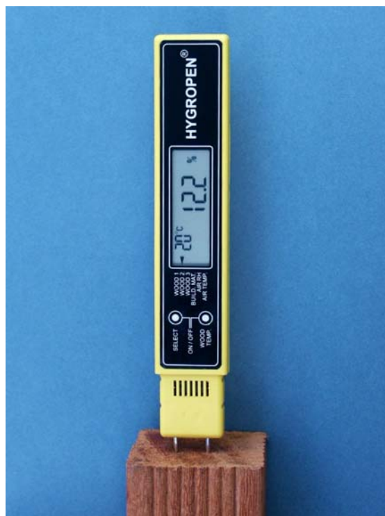
Rys.1 Wilgotnościomierz rezystancyjny typ HYGROPEN produkcji firmy TANEL
